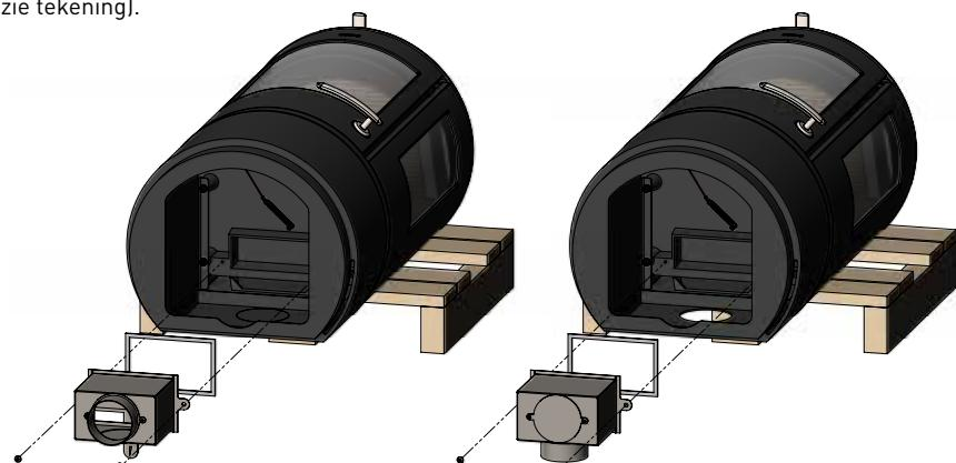
Als de aansluiting voor frisse lucht achteraan wordt geplaatst, moet het plaatstaal paneel aan de achterkant van de mof met voorzichtige tikjes worden uitgeslagen bij de smalle "bruggen" die het paneel vasthouden.
