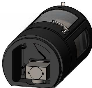
När du har monterat önskad sockel placerar du kaminen försiktigt på baksidan, eventuellt på träemballaget som kaminen levererades på. Vid montering av friskluftsbox måste du se till att det finns utrymme för luftspjället som öppnas bakåt (se skiss).
