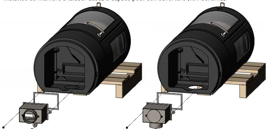
Si la prise d'air est orientée vers l'arrière, la plaque d'acier prédécoupée à l'arrière du poêle doit être retirée en tapant avec un marteau sur les petits ponts qui la retiennent. Frappez avec précision des petits coups nets et fermes sur les petits ponts.
