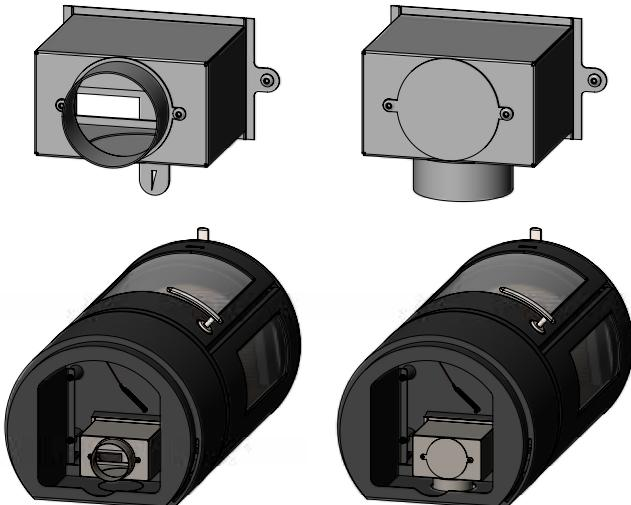
Nach der Montage des gewünschten Sockels den Ofen in stabiler Lage auf der Rückseite ablegen, eventuell auf der Holzverpackung, mit der der Ofen geliefert wurde. Bei der Montage der Frischluftbox muss sichergestellt sein, dass Platz für die Luftklappe vorhanden ist, die sich nach hinten öffnet (siehe Abbildung).
