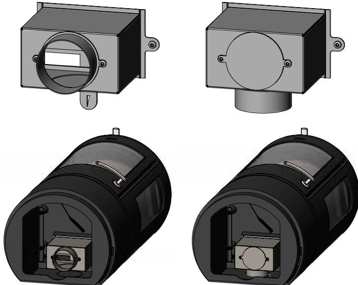
Etter at den ønskede sokkelen er montert, plasseres ovnen forsiktig på baksiden, eventuelt på treemballasjen den ble montert på. Ved montering av friskluftboksen må man forsikre seg om at det er plass til luftespjeldet, som åpnes bakover (se tegningen).
