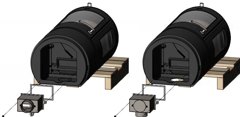
Wenn der Frischluftanschluss nach hinten geführt werden soll, muss das Eisenplättchen an der Rückseite mit einem Hammer mit kurzen festen Schlägen vor den kleinen „Brücken“, mit denen das Plättchen befestigt ist, herausgeschlagen werden.
