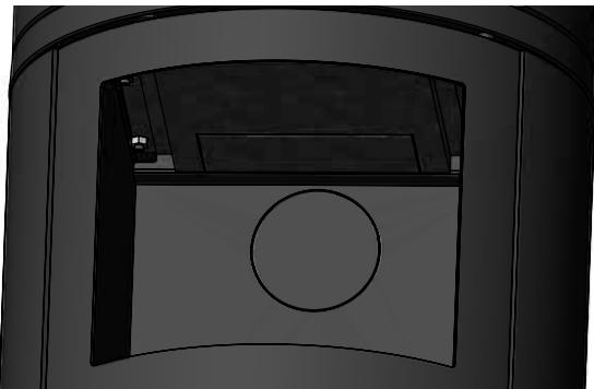
Prima di installare l'airbox di ventilazione su questi modelli, è necessario rimuovere i due blocchi rettangolari presenti sullo schermo paracalore (vedere schema).
