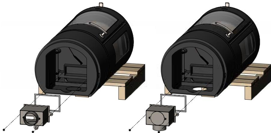
Hvis frisklufttilkoblingen skal føres bakover, skal platejernstykket på baksiden av sokkelen slås ut med små bestemte slag ved siden av de små "broene" som holder stykket på plass. Det medfølgende keramiske glassbåndet, som fungerer som pakning mellom friskluftboksen og den støpte bunnplaten, monteres på friskluftboksen, som deretter skrus fast på ovnen med de 2 medfølgende skruene.
