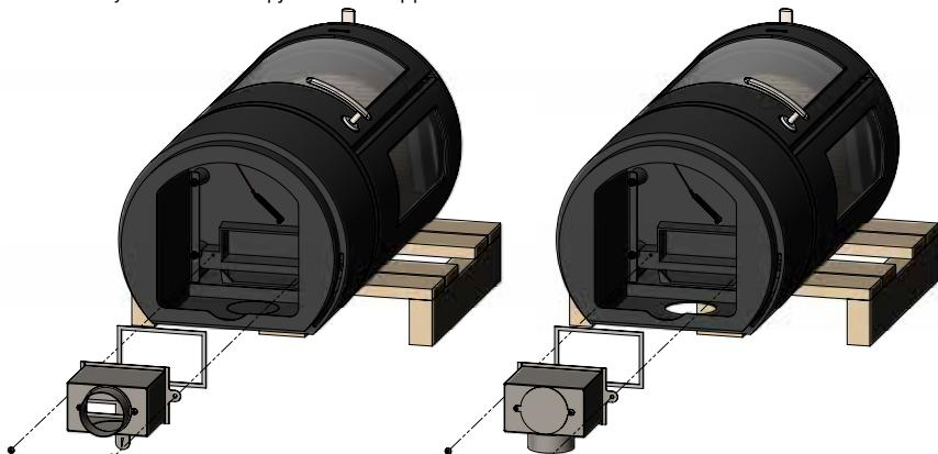
Om du vill ha friskluftsanslutningen bakåt måste du slå ut plåtbrickan på baksidan av sockeln med små bestämda slag eftersom de små "broarna" håller plattan på plats. Sätt fast den bifogade keramiska glasfibertejpen som tjänar som en tätning mellan friskluftsboxen och den gjutna bottenplattan på friskluftsboxen, som sedan skruvas fast på kaminen med de två bifogade skruvarna.
