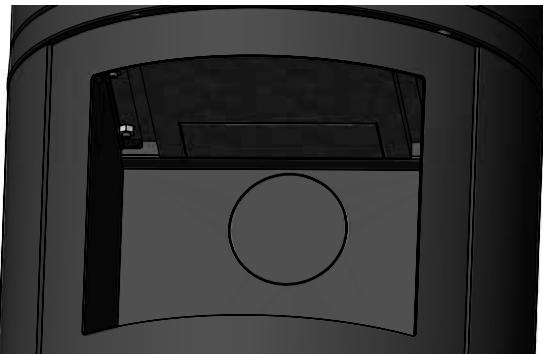
Antes de instalar la caja de aire fresco en estas versiones se deben retirar los dos bloques rectangulares de la pantalla térmica (véase el esquema).
