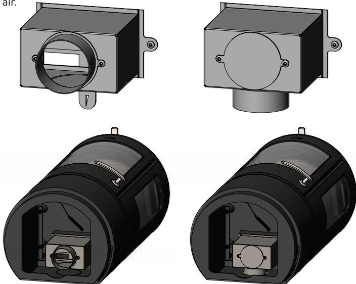
Après l'installation de la prise, le poêle peut être précautionneusement couché sur sa face arrière, le sol et le poêle étant protégés avec le carton d'emballage. La prise d'air doit être installée de manière à laisser assez d'espace pour son ouverture (voir schéma).
