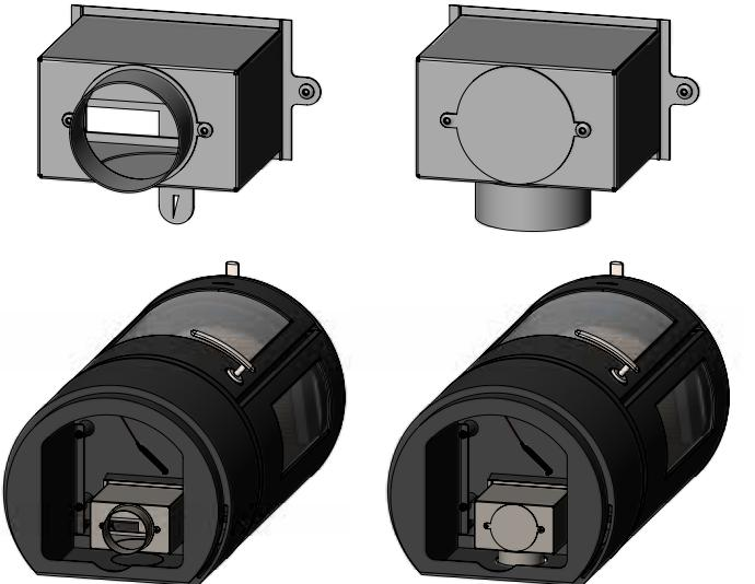
Después de instalar el receptáculo requerido, la estufa se debe poner en el suelo con cuidado sobre su parte trasera (posiblemente, sobre el embalaje de envío). La Caja de Aire Fresco se debe instalar de forma que quede espacio para el regulador de tiro de aire, el cual se abre hacia atrás (véase el esquema).
