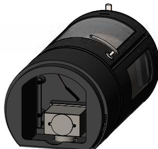
Nadat u de vereiste mof hebt geplaatst, moet de kachel voorzichtig op de achterkant worden gelegd, indien mogelijk op de verpakking waarin ze is geleverd. De Fresh Air Box moet worden geplaatst om ervoor te zorgen dat er plaats is voor de luchtregekllep, die achteraan opengaat (zie tekening).
