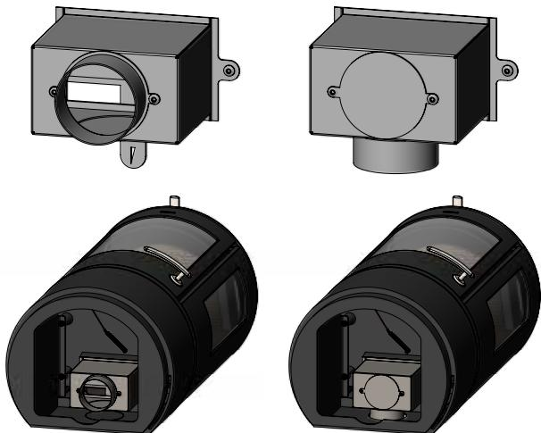
Una volta completata l'installazione dell'attacco, la stufa deve essere adagiata al suolo, facendola poggiare sul lato posteriore, possibilmente dopo aver steso al suolo un pezzo del cartone di imballaggio. L'airbox di ventilazione deve essere installato in modo tale da garantire spazio sufficiente per la valvola di tiraggio, che si apre sul retro (vedere schema).
