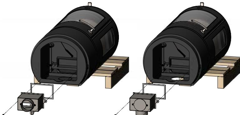
Se il condotto di ventilazione deve essere installato sul retro della stufa, il pannello in acciaio posto sul lato posteriore dell'attacco, deve essere rimosso mediante leggeri colpetti sui piccoli "ponticelli" che fissano il pannello in posizione.
