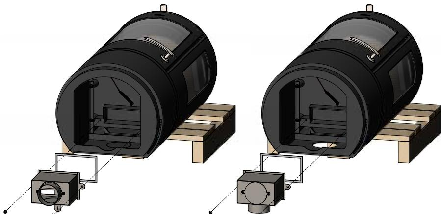
Ønskes frisklufttilslutningen ført bagud skal pladejernsbrikken på bagsiden af soklen slås ud med små kontante slag ud for de små "broer", der holder brikken på plads.
