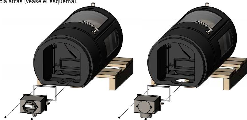
Si la conexión de aire fresco se debe instalar hacia atrás, la chapa de acero de la parte posterior del receptáculo se quita dando ligeros golpes de martillo en los pequeños "puentes" que la sujetan.
